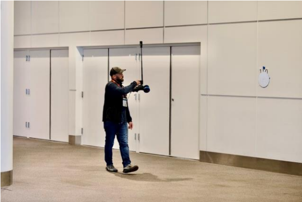
図 5. GCP の近くで歩行スキャンを行う Emesent のチームメンバー (左)、標準的なチェッカーボード GCP の上に設置された Emesent の反射ディスク GCP (右)。
