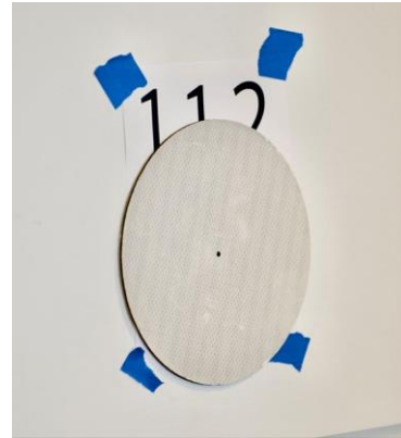
図 5. GCP の近くで歩行スキャンを行う Emesent のチームメンバー (左)、標準的なチェッカーボード GCP の上に設置された Emesent の反射ディスク GCP (右)。
